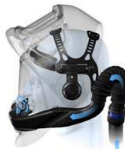
För att uppnå en hög skyddsklass på andningsskyddet finns luftutsläppet i direkt anslutning till munnen och näsan. En deflektor sprider luftflödet maximalt.
