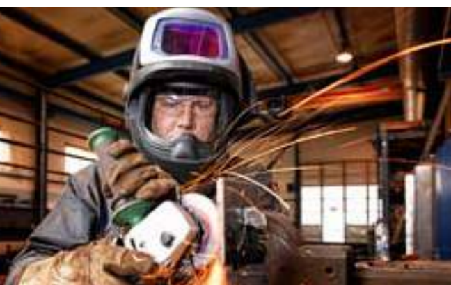
Ett gnist- och stänktåligt skydd över hjässan är standard på alla 3M™ Speedglas™ svetshjälm i 9100 FX-serien.
